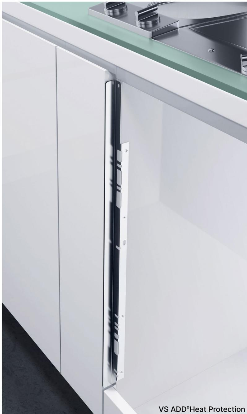
Термоизоляционная планка предотвращает нагрев и повреждение фасадов и кромки, примыкающих к духовому шкафу. Монтируется по краям тумбы под духовой шкаф. Подходит для корпуса толщиной 16 мм.
