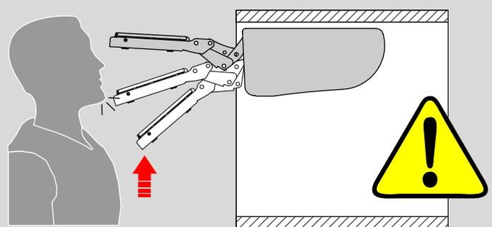
Будьте осторожны при фиксации подъемника
